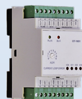
Modul proporcionální řízení 4x 0-10V
