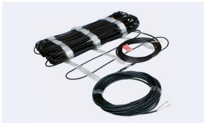
► **Cable calefactor ADSV+** – cable bifilar con capa protectora completa. La envuelta del cable es capaz de resistir a la radiación UV. Puede utilizarse sobre todo para la calefacción por suelo y para quitar hielo y nieve de los techos y canalones de techos. Extremo frío 1×3 m. Ø 5,0 mm. 230 V.
