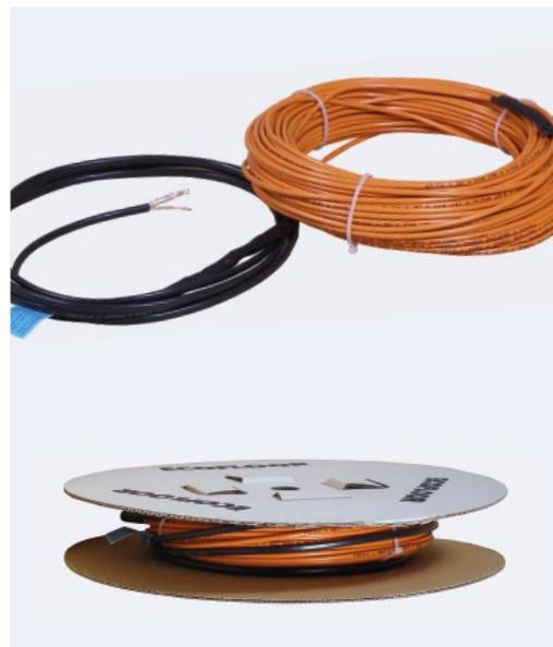
► **Cable calefactor ADPSV** – cable bifilar con capa protectora completa es conveniente para la calefacción por piso radiante, realizado por semiacumulación y acumulación de calor en lugares de vivienda. Clase M2. Extremo frío 1x5m. Ø 5,3–5,9 mm. 230 V.
