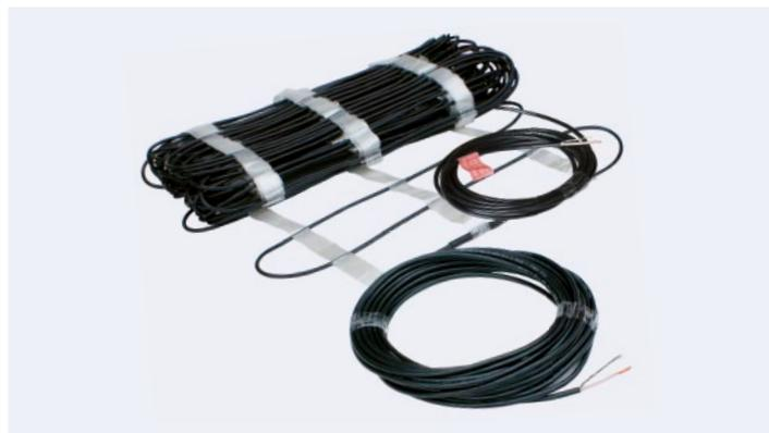
► **Câble chauffant ADSV+** – un câble chauffant à deux âmes sous tresse. L'enveloppe du câble est résistante à la radiation solaire. Il est destiné au chauffage au sol, à l'évacuation de la glace et de la neige des toits et des égouts. L'extrémité froide 1×3 m. Ø 5,0 mm. 230 V.
