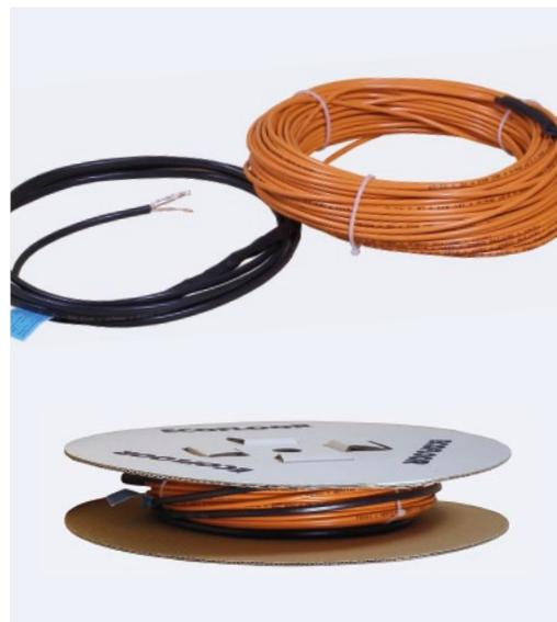
► **Câble chauffant ADPSV** – à deux âmes avec le guipage de protection complet est convenable pour le chauffage à semi-accumulation et d'accumulation par plancher dans les espaces habités. Classe M2. Câble de connexion – extrémité froide 1x5 m. Ø 5,3–5,9 mm. 230 V.
