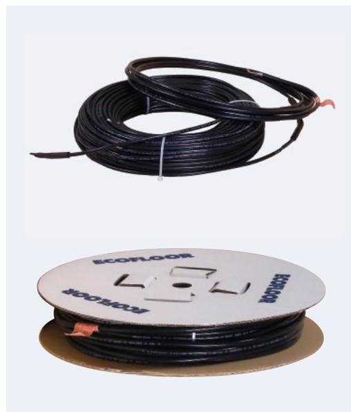
► **Câble chauffant PSV** – à une âme avec le guipage de protection complet pour le chauffage d'accumulation et à semi-accumulation. Câble de connexion – extrémité froide 2x5 m. 230 V. Ø 4,5–4,8 mm.
